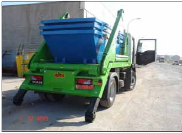
CONTENEDOR DE OBRA COGIDA POR EQUIPO DE CADENA
